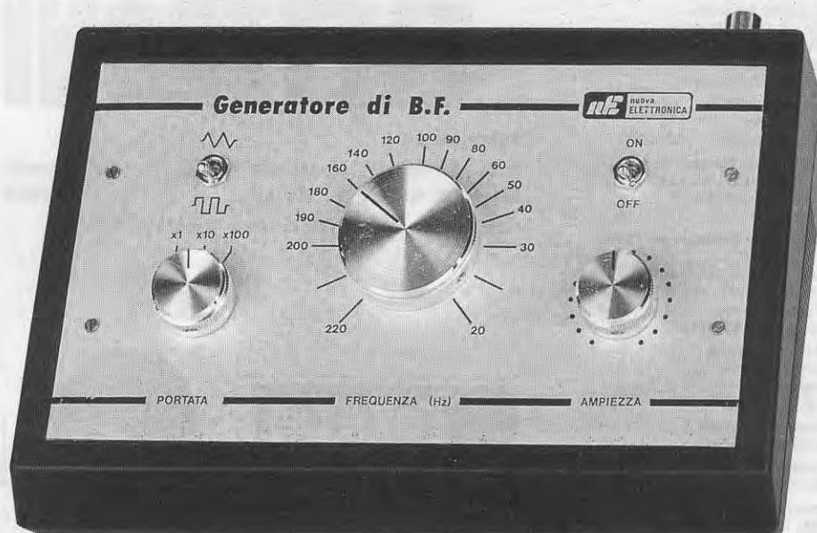
Fig.1 Come si presenta il Generatore di BF completo della sua mascherina forata e serigrafata.
