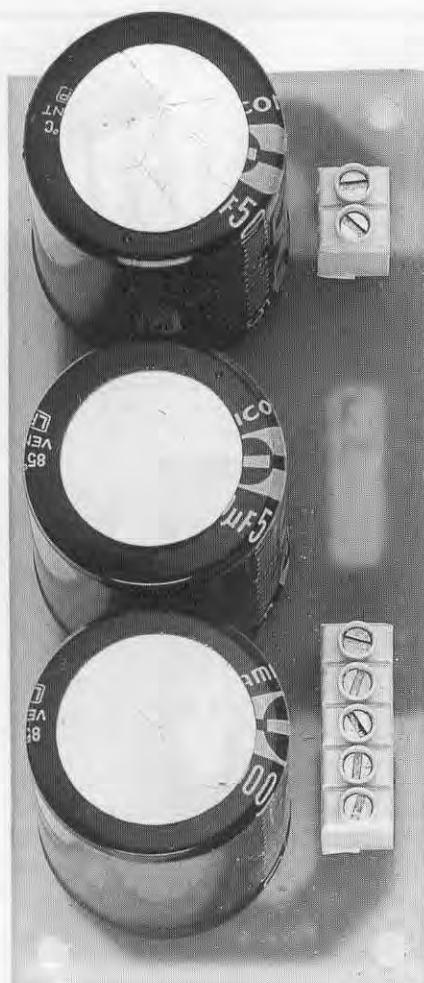
Fig.5 Sullo stampato LX.1147/B, i tre elettrolitici e le morsettiere vengono normalmente montati sul lato opposto al rame.
