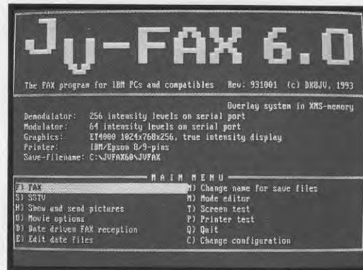
Fig.22 Per ricevere le immagini dei satelliti meteorologici, quando sarete nel menu principale, dovete premere il tasto F e poi pigiare uno dei tasti riportati nella Tabella N.1.
