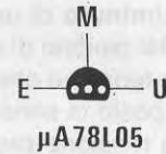
Fig.11 Connessioni dell'integrato LM.231 viste da sopra e dell'integrato \mu A.78L05 viste da sotto.
